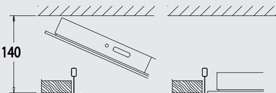
Installazione seguente al montaggio del controsoffitto, in appoggio sulla struttura in vista, intercapedine minima di 140 mm dal filo inferiore della struttura.
